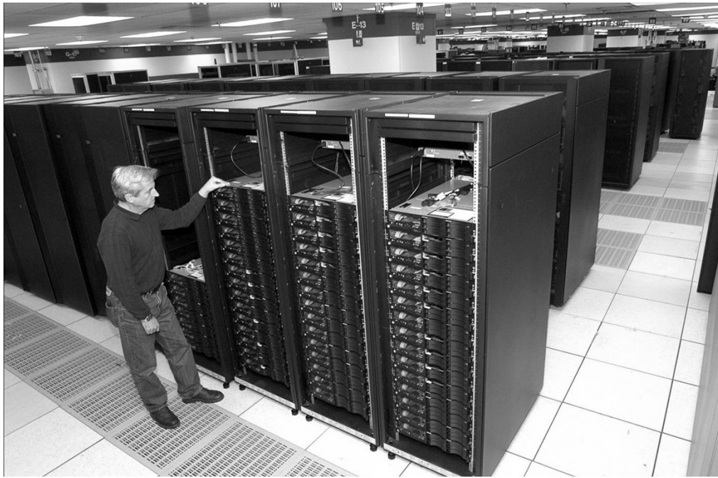
Az IBM által épített Roadrunner szuperszámítógép a világon elsőként érte el hivatalosan az 1 petaFLOPS-os ( 10^{15} FLOPS) lélektani teljesítményhatárt, ami 1 billiórdlebegőpontos művelet másodpercenkénti végrehajtását jelenti. (2008)
